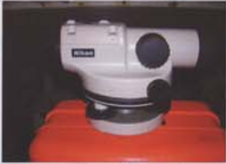
Automatic Level Model AV 7
