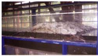
Uji Fisik Breakwater
