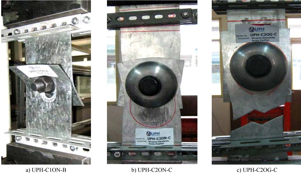
Gambar 5. Keruntuhan yang terjadi pada eksperimen
